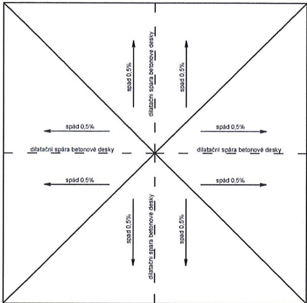
Provedení dilatací není nutností, ale volbou pro danou lokalitu (podloží) je betonová deska vždy pfeleta tartanovým povrchem.
